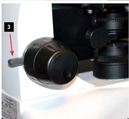
Рис. 2. Рукоятки управления микроскопа: 1 — рукоятка перемещения конденсора; 2 — рукоятка управления координатного стола; 3 — коаксиальная рукоятка фокусирующего механизма со стопорным кольцом.
