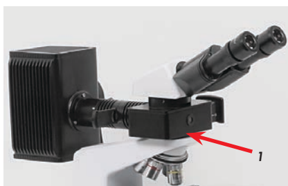
Рис. 4. Люминесцентный модуль: слева люминесцентный осветитель отраженного света с окном для контроля положения светящегося тела (1) ртутной лампы; справа представлен узел крепления блоков люминесцентных светофильтров (2) и подвижная вставка для ослабляющих светофильтров (3).
