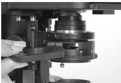
Рис. 5. Конденсор Аббе А 1,25 с апертурной диафрагмой и вставкой для реализации различных методов контрастирования: светлое поле/темное поле (BF/DF) или светлое поле/фазовый контраст (BF/PH) или светлое поле/темное поле/фазовый контраст (BF/DF/PH).
